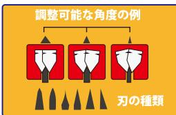
重力によるビンチング方式であらゆる角度の包丁が研げます。
